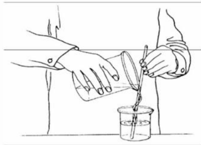
(الشكل ٩): استخدام محرك زجاجي كدليل للسائل المسكوب
